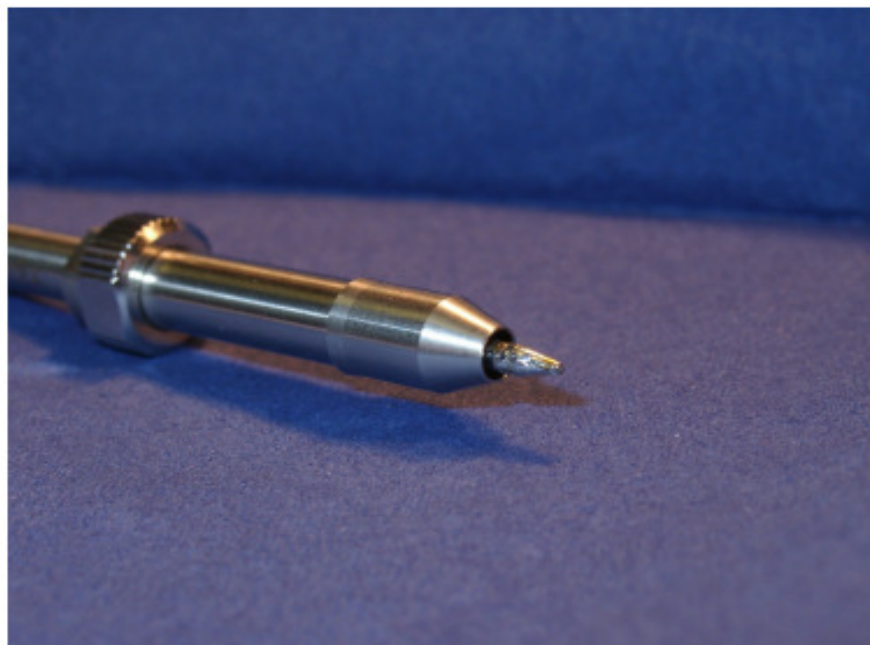
Abb. 8: Ringdüse um die Lötspitze - Austrittsstelle für den heißen Stickstoff. (Quelle TBK)
