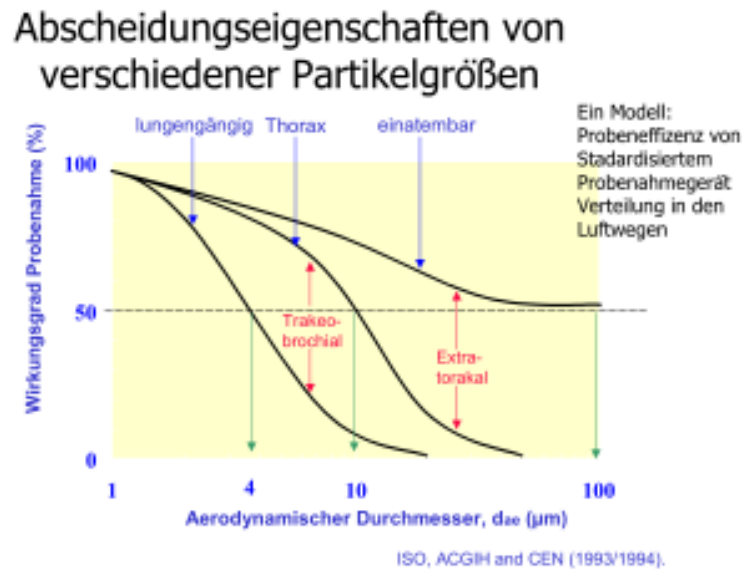
Abb. 6: Verteilung der eingeatmeten Partikel unterschiedlicher Größen bei der Anlagerung in den Atemwegen. (Quelle FILTRONIC)
